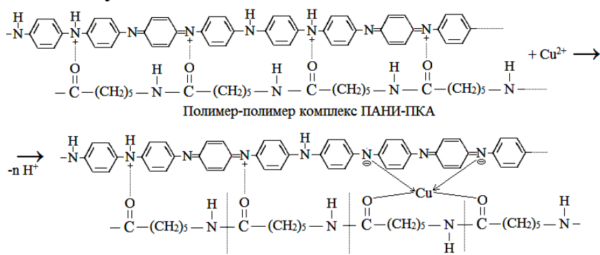
Схема 4. Реакция комплексообразование с ионами меди в комплекс ПАНИ-ПКА
