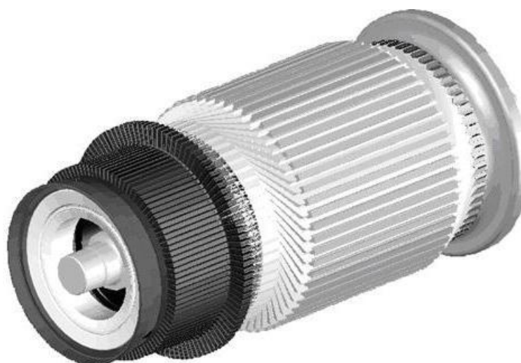
5.6.-rasm. Tortuv elektr dvigateli yakorining umumiy ko'rinishi
