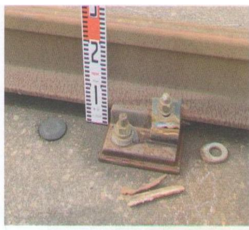
8.2-rasm. 2004 yil 31 oktabr zilzilasi oqibatlarini: a – uzilib ketgan rels mahkamlagichlari; b – estakadada plitali asosga yotqizilgan va zilzila vaqtida qiyshayib ketgan va buzilgan relslar
