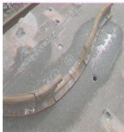
8.2-rasm. 2004 yil 31 oktabr zilzilasi oqibatlarini: a – uzilib ketgan rels mahkamlagichlari; b – estakadada plitali asosga yotqizilgan va zilzila vaqtida qiyshayib ketgan va buzilgan relslar
