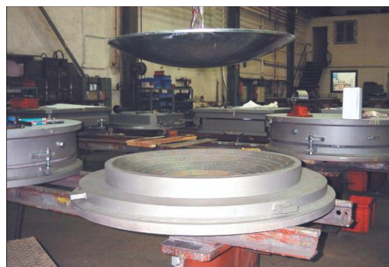
4.5-rasm. Fransiyaning A75 avtostradasidagi Millau viadukining sharli seysmoizolyasiyalovchi tayanch qismlari
