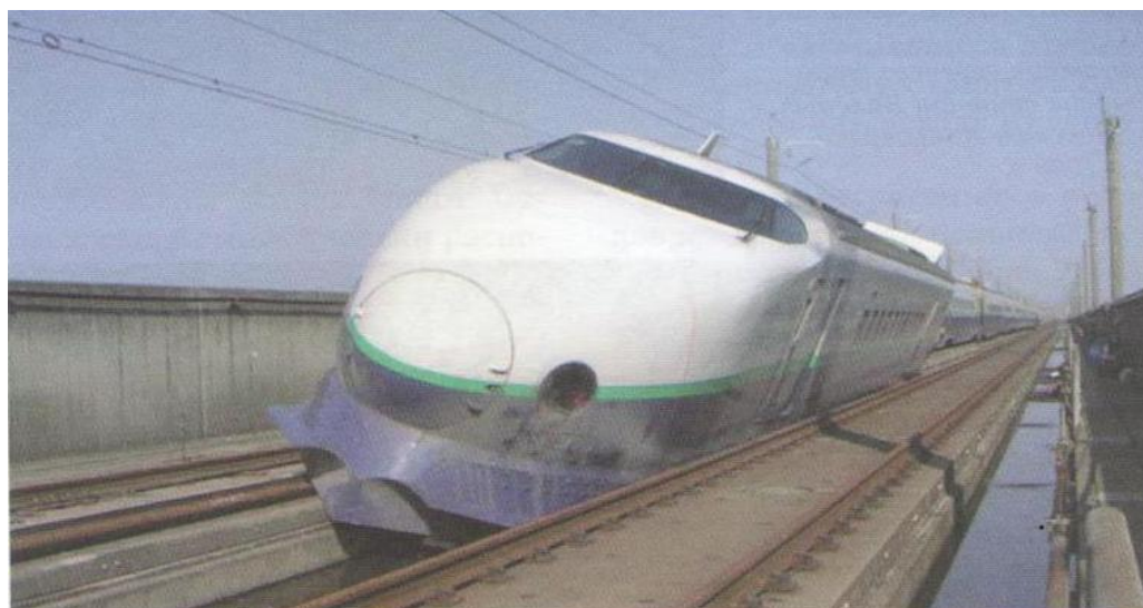
8.1-rasm. 2004 yil 31 oktabr zilzilasi vaqtida estakadada to‘xtagan “Dzyoesu–Sinkansen” poyezdi, seysmik zarba natijasida relslardan chiqib ketgan vagon
