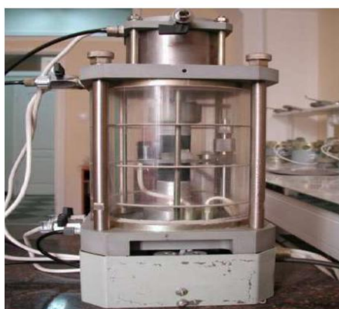
11.3-rasm. Stabilometrni umumiy koʻrinishi
