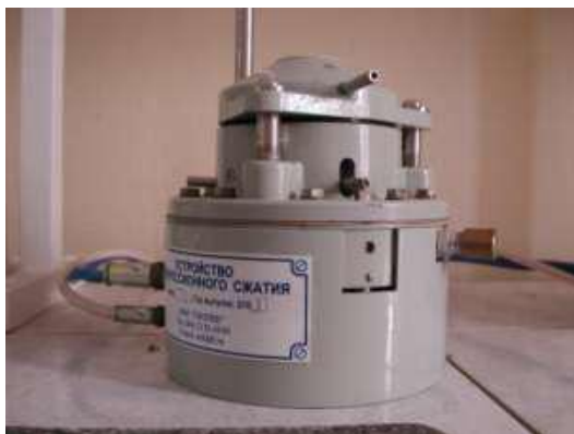
6.1-rasm. Kompression asbob sxemasi va umumiy ko'rinishi (Odometr):
