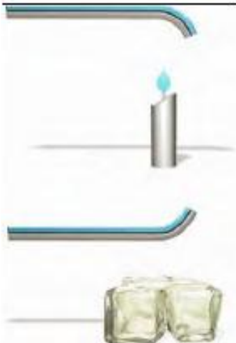
10-расм. Биметалл пластинкалар. Уни иситилганда ва совитилганда, бу икки металл турли миқдорда кенгаяди ёки сиқилад, натижада пластинка егилади.
