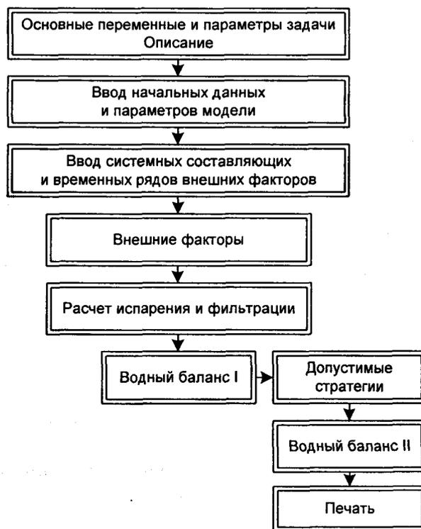
Рис. 12.4. Блок-схема расчета водного баланса на ЭВМ
