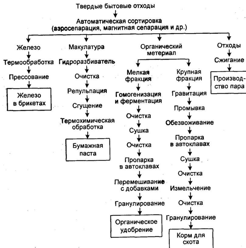
*Рис. 4.8. Принципиальная схема промышленной переработки твердых бытовых отходов*
