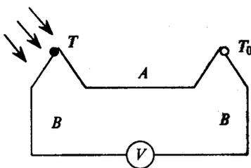
Рис. 14.2. Термопара, состоящая из материала А и В
