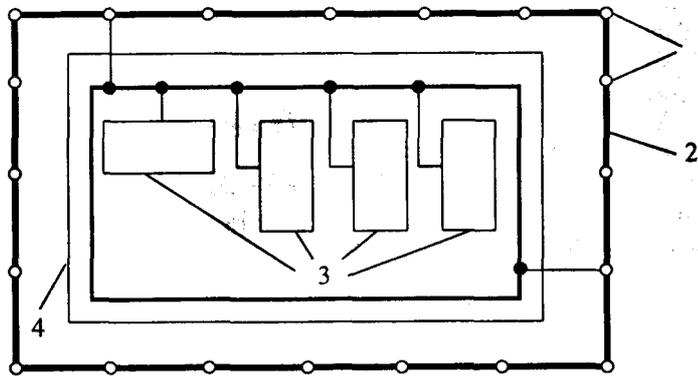
Рис. 20.5. Схема контурного заземления:
