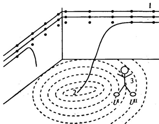
**Рис. 20.2. Схема возникновения шагового напряжения:**
