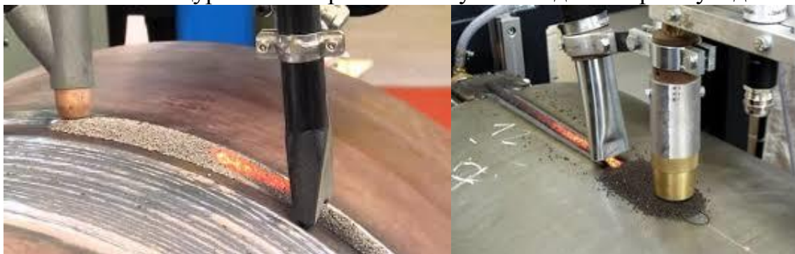
9.1-расм. Флюс остида автоматик пайвандлаш жараёни
