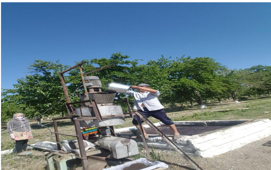
2.5.1-расм. Тут мевасини эзиб берадиган эски типдаги ускуна
