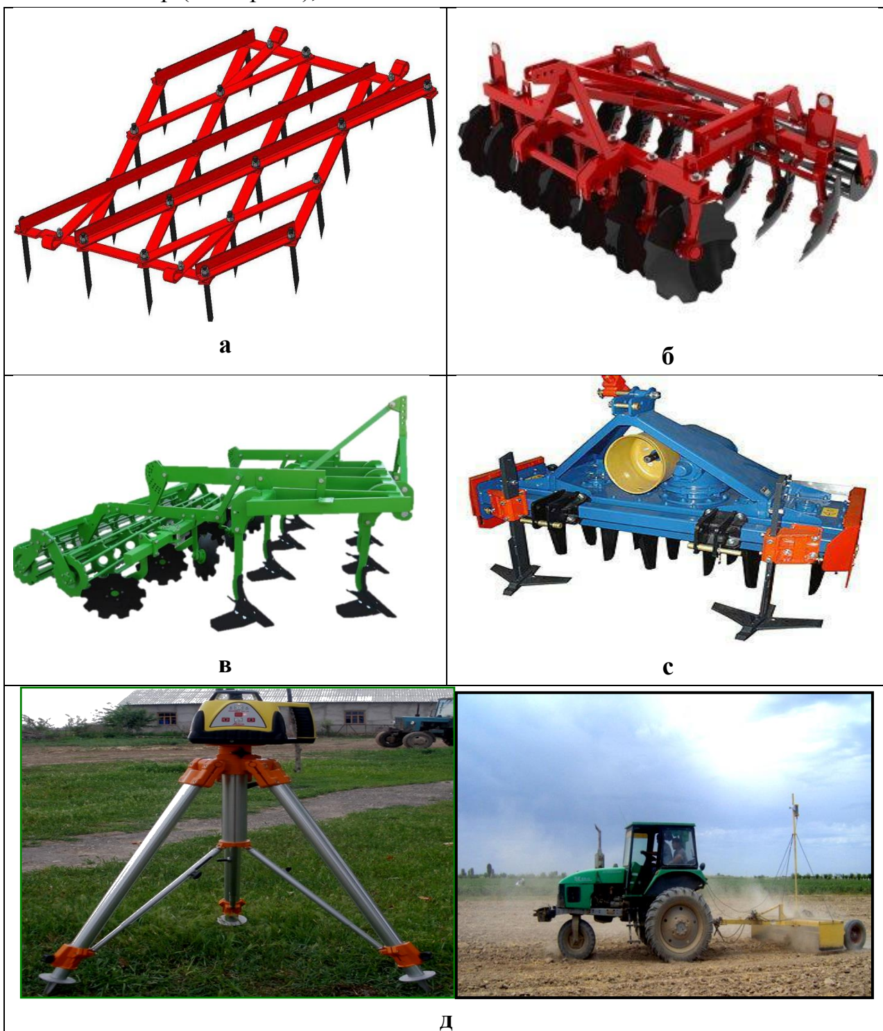
2.7-расм. Тупроққа саъз ишлов бериш машиналари. а) тишли борона; б) дискли борона; в) чизел култиватор; с) тупроқ фрезаси; д) лазарли ер текислагич.
