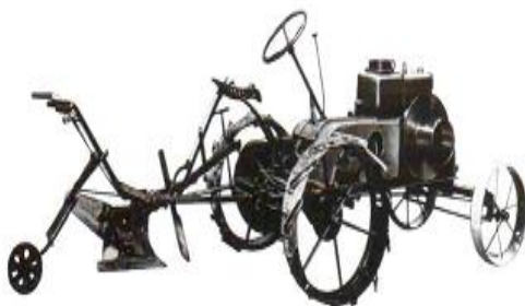
1.3-расм. Трактор ва плугни агрегатлашда уч нуктали улаш қурилмаси билан жихозланиши.
