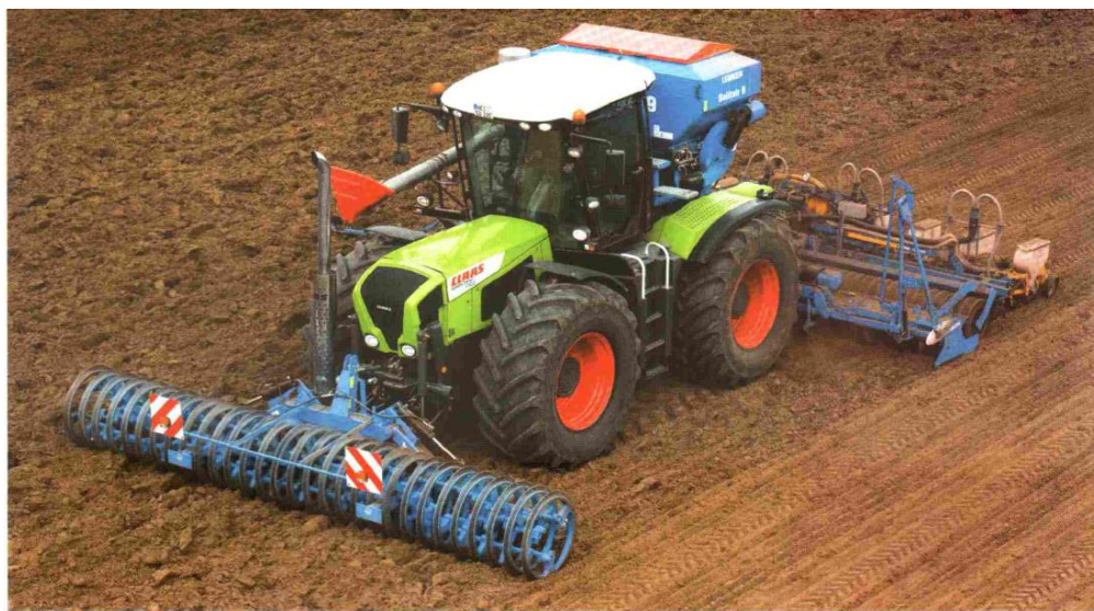
1.4-расм. Claas фирмасининг Xerion модели тракторига агрегатланган ерни юмшатиш ва уруғ экиш агрегати.
