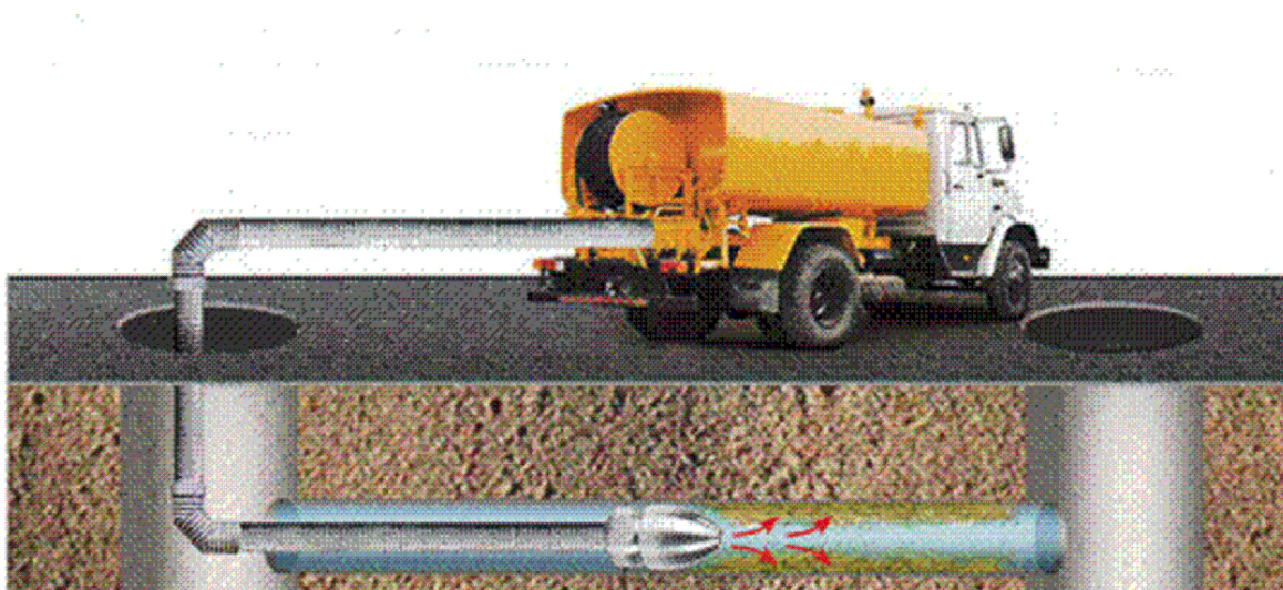
5.3 -расм.Тармоқларни гидродинамик тозалаш услуби
