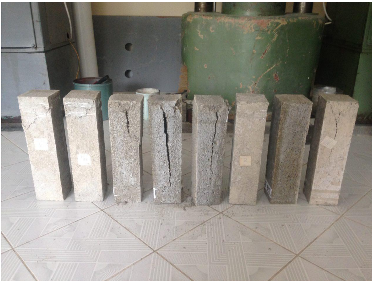
3.8-расм. Тажрибадан ўтказилган призма намуналарнинг умумий кўриниши
