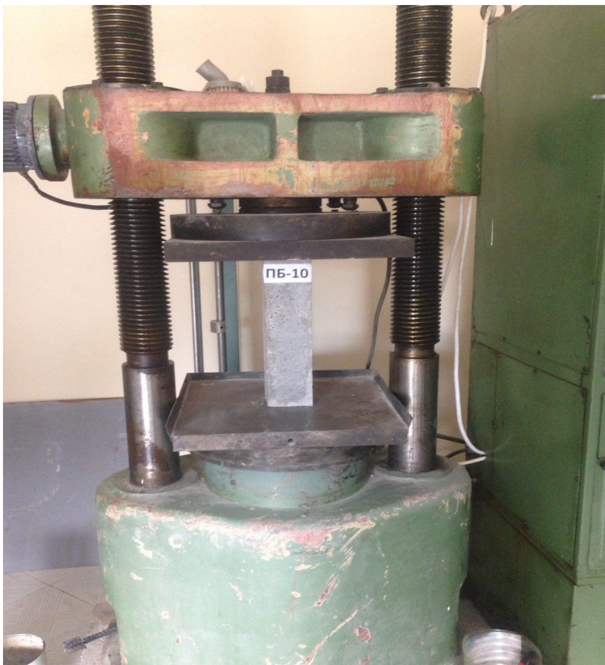
3.4-расм. Оддий енгил бетоннинг призмaviй мустаҳкамлигини аниқлаш
