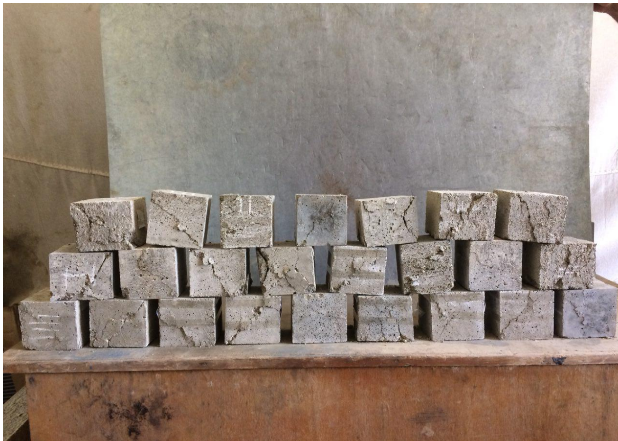
3.7-расм. Тажрибадан ўтказилган куб намуналарнинг умумий кўриниши
