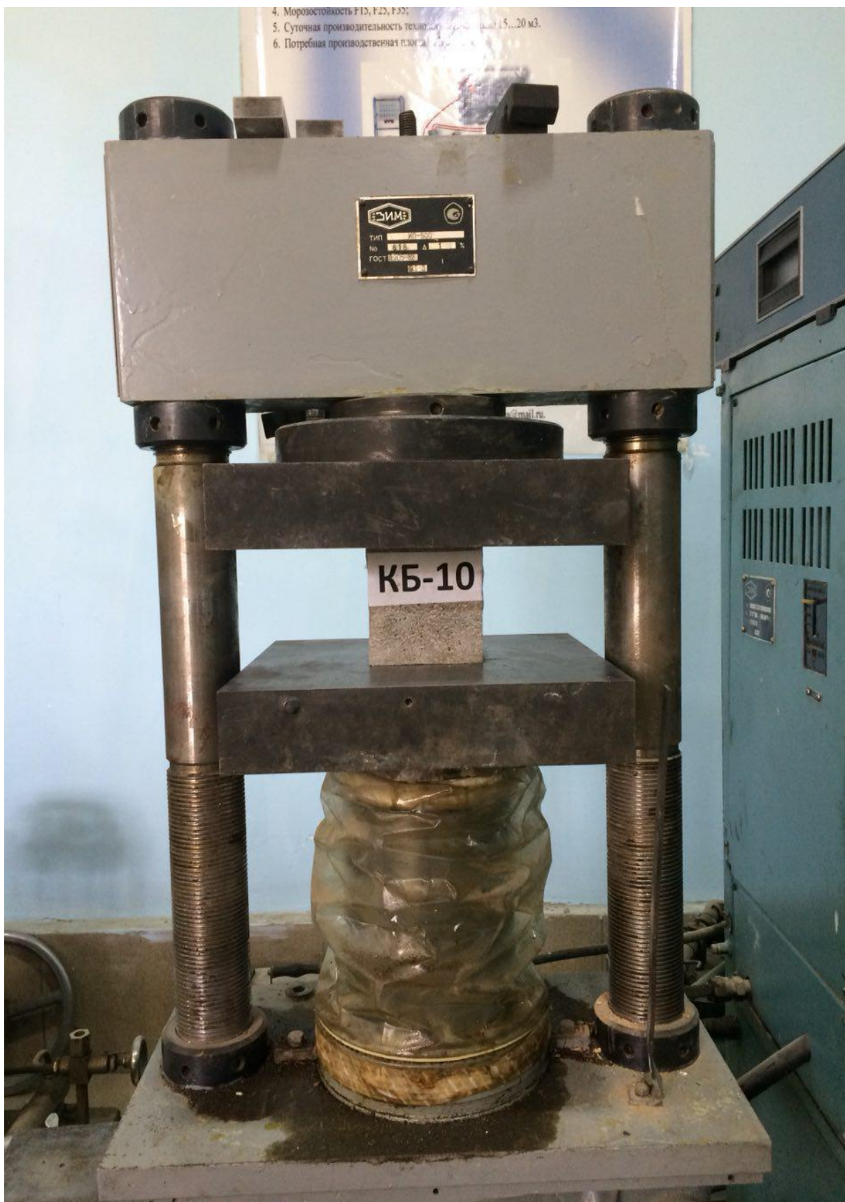
3.1-расм. Оддий енгил бетонларнинг кубик мустаҳкамлигини аниқлаш.
