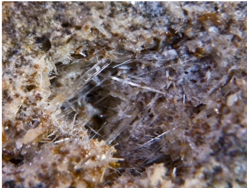
2.5-расм. Волластонитнинг микронасимон тузилиши (1700 марта катталаштириб олинган).
