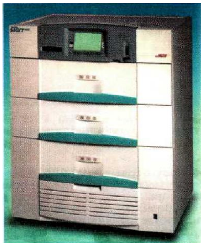
Микобактерия ўсишини рўйхатга олувчи ва уларни химиопрепаратларга сезгирлиги-ни аниқловчи BACTEC MGIT 960 автоматлаштирилган комплекси
