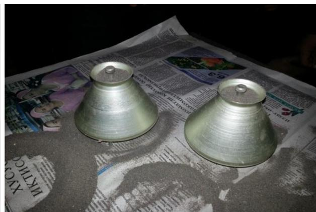
1. Прибор устанавливается в горизонтальную поверхность лабораторного стола и постепенно через воронку заполняется песком.
