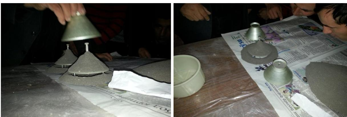
4. После того как песок перестанет осыпаться, конус приподнять вверх и снять с прибора.
