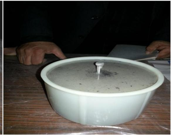
4. После насыщения песка водой, что видно по изменению цвета песка(через отверстия в подставке), коническая часть прибора плавно, на 1-2 мм., приподнимается над подставкой так, чтобы песок очень медленно высыпался из прибора в пластмассовую чашку с водой. После того как песок перестанет осыпаться, конус приподнять вверх и снять с прибора.
