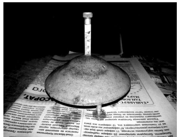
5. После того как песок перестанет осыпаться, подставку с оставшийся частью песком приподнять вверх и снять из чашки с водой.
