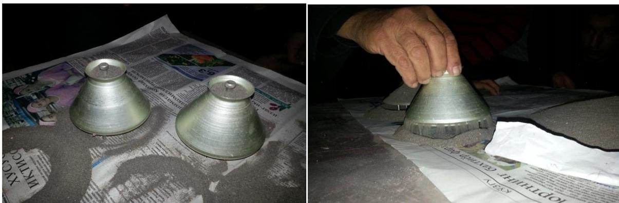
3. После заполнения прибора песком, коническая часть прибора плавно, на 1-2 мм., приподнимается над подставкой так, чтобы песок очень медленно высыпался из прибора .
