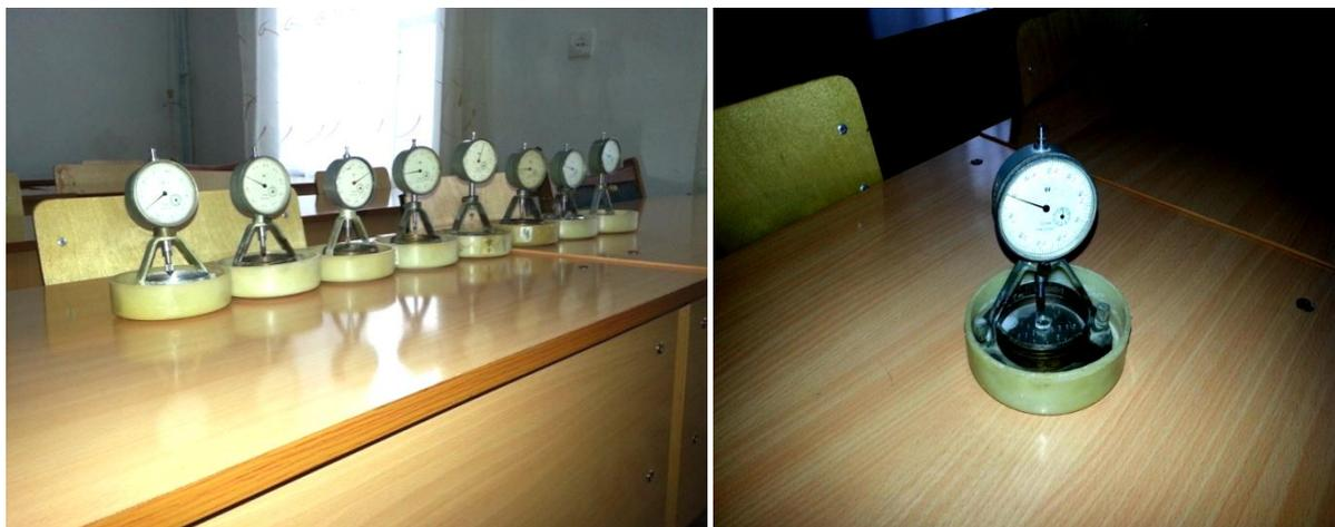
IV.2.1.2. Конструкция ПНГ должна быть выполнена из материалов, стойких против коррозии, и обеспечивать: неподвижность рабочего кольца при испытании; подачу воды к образцу снизу и отвод ее; величину вертикального давления от штампа, измерительного оборудования, расположенного на нем, и других неуравновешенных деталей не более 0,0006 МПа (0,006 кгс/см<sup>2</sup>).
