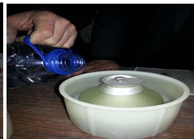
3. Вода доливаеся в чашку так, чтобы она лишь на 2-3 мм не доходила до верха прибора.
