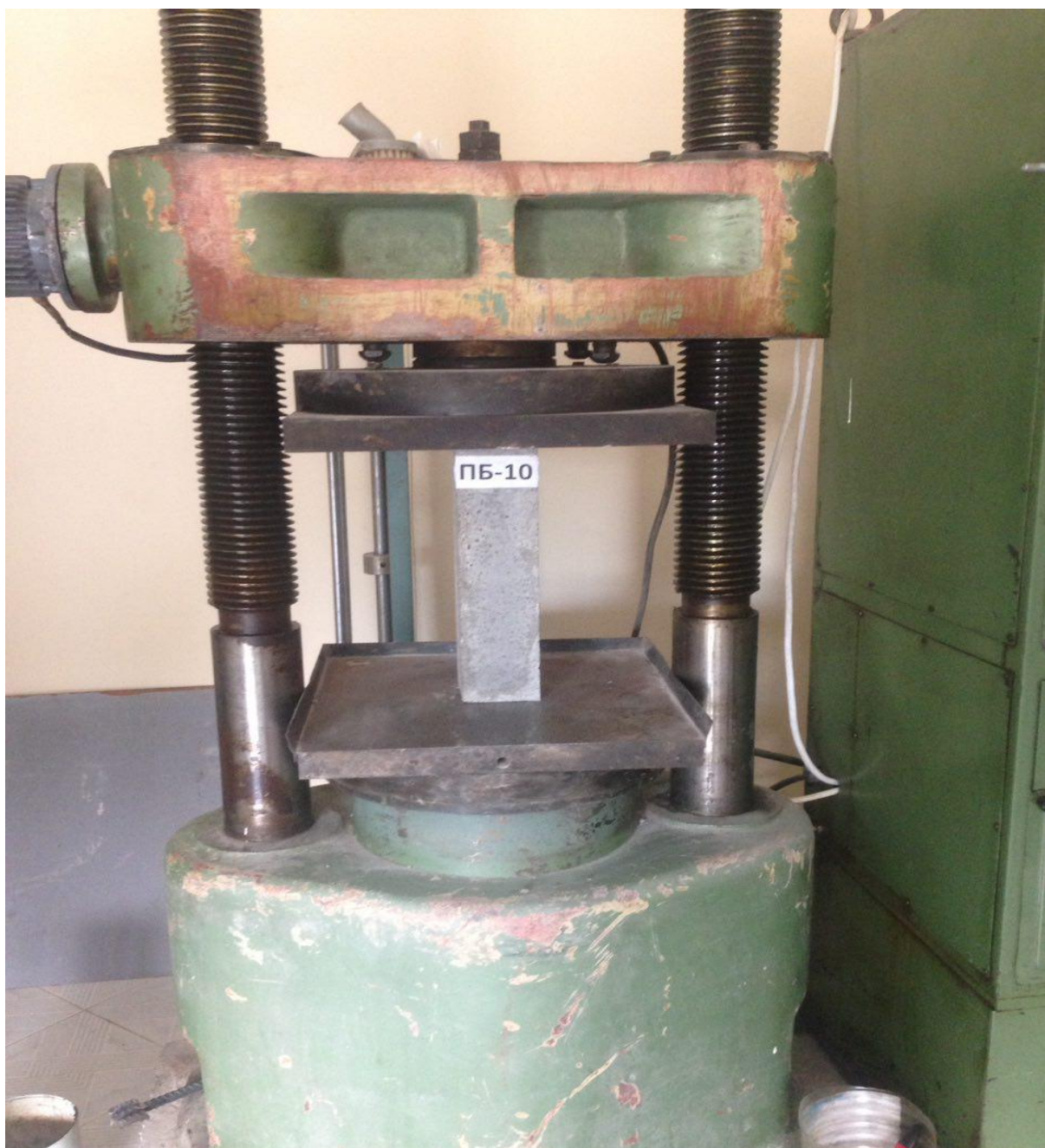
3.4-расм. Оддий енгил бетоннинг призмавий мустаҳкамлигини аниқлаш
