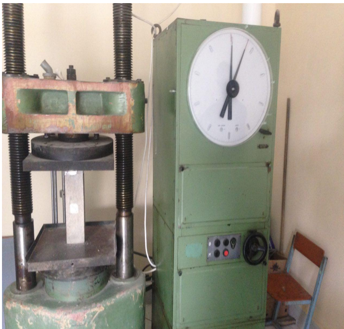
3.5-расм. Волластонит минерали қўшилган вермикулитбетонларнинг призмавий мустаҳкамлигини аниқлаш.
