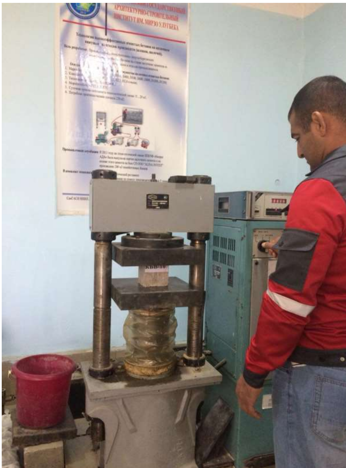
3.2-расм. Волластонит минерали қўшилган енгил бетонларнинг кубик мустаҳкамлигини аниқлаш.
