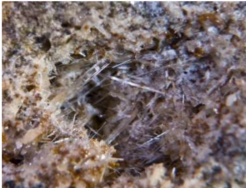
2.5-расм. Волластонитнинг микронасимон тузулиши (1700 марта катталаштириб олинган).
