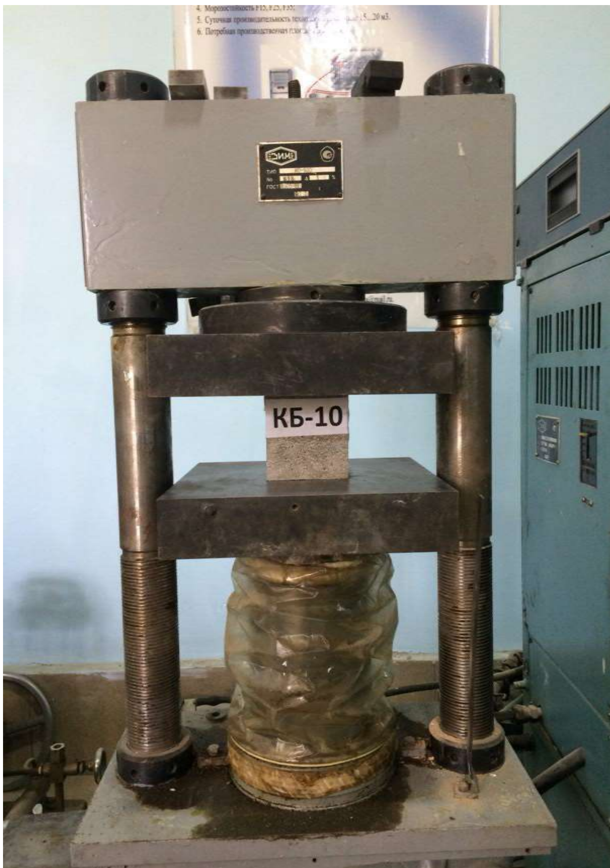
3.1-расм. Оддий енгил бетонларнинг кубик мустаҳкамлигини аниқлаш.
