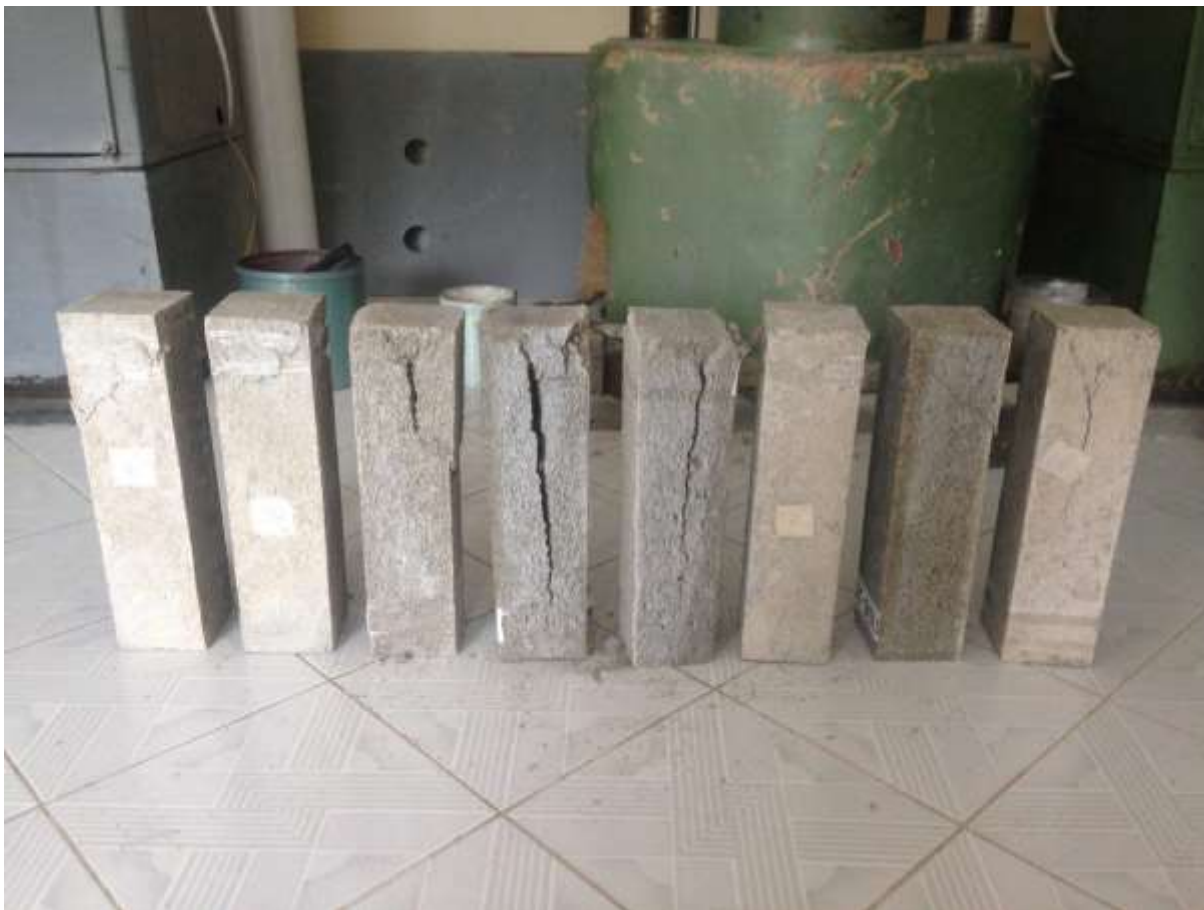
3.8-расм. Тажрибадан ўтказилган призма намуналарнинг умумий кўриниши
