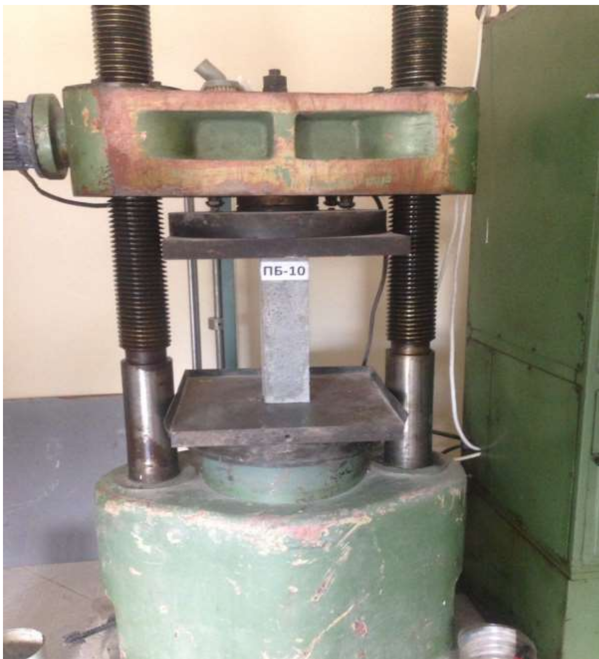
3.4-расм. Оддий енгил бетоннинг призмавий мустаҳкамлигини аниқлаш
