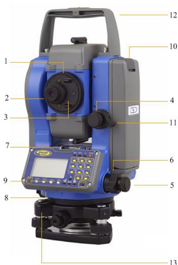
16-расм. Фосус 4 электрон тахеометрининг ташқи кўриниши ва асосий қисмлари.
