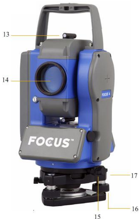
16-расм. Фосус 4 электрон тахеометрининг ташқи кўриниши ва асосий қисмлари.
