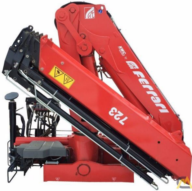
-rasm. Ferrari 723R A4 KMU (yuk ko'taruvchanligi 30 tonna)
