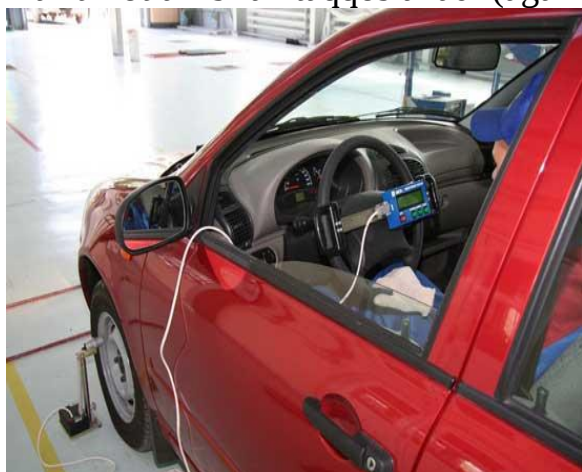
14.5-rasm. - Рул бошқармасининг люфтлар йиғиндисини аниқловчи ИСЛ-М курилмаси
