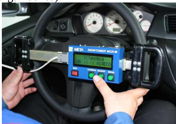
14.5-rasm. - Рул бошқармасининг люфтлар йиғиндисини аниқловчи ИСЛ-М курилмаси
