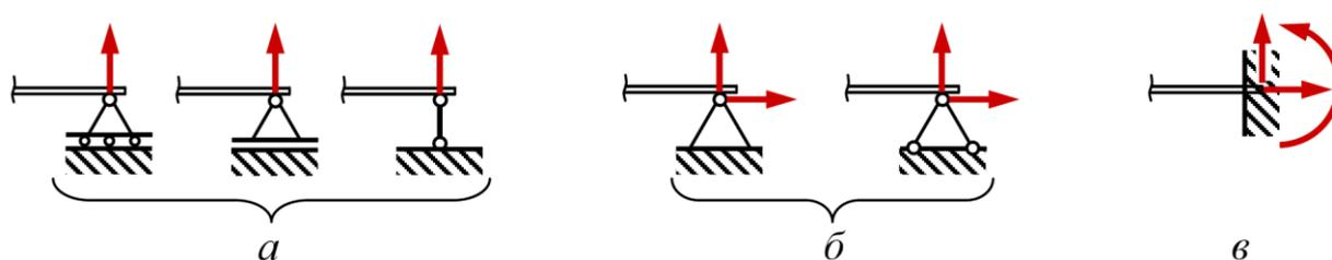
Рис.4.7. Схемы опорных устройств варианты их изображения:
