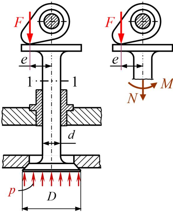
**Решение:** Сила давления газов на тарелку клапана
