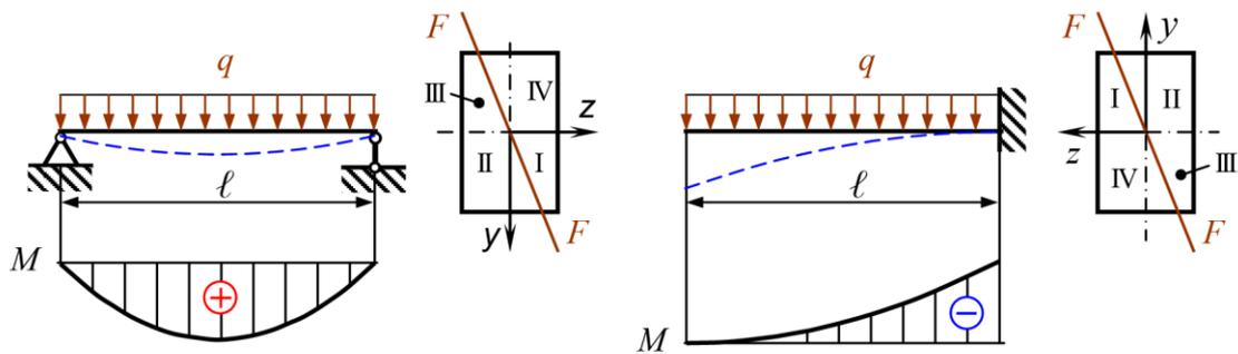
Рис. 4.65. Примеры выбора направления координатных осей при косом изгибе
