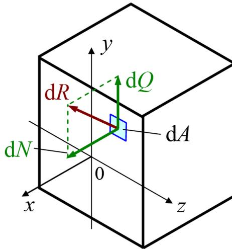
Рис. 4. 11. Разложение элементарного внутреннего усилия на составляющие.
