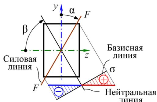
2. Углы  $\alpha$  и  $\beta$  в уравнении (8.4) имеют разные знаки, следовательно, силовая и нейтральная линии лежат в разных плоскостях. Углы  $\alpha$  и  $\beta$  откладываются в одном направлении, но от разноименных осей (см. Рис.4.63,в).
