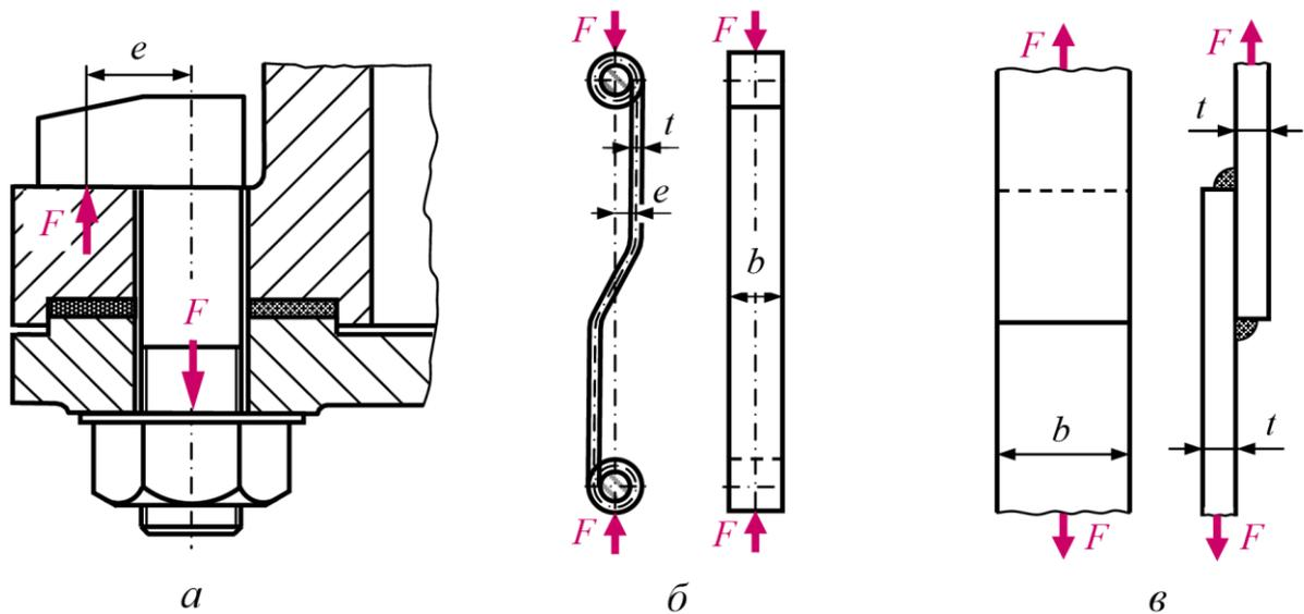
Рис.4.67 . Примеры деталей и узлов, работающих при внецентренном нагружении: а–болт-костыль; б–пружина сцепления; в–сварное соединение
