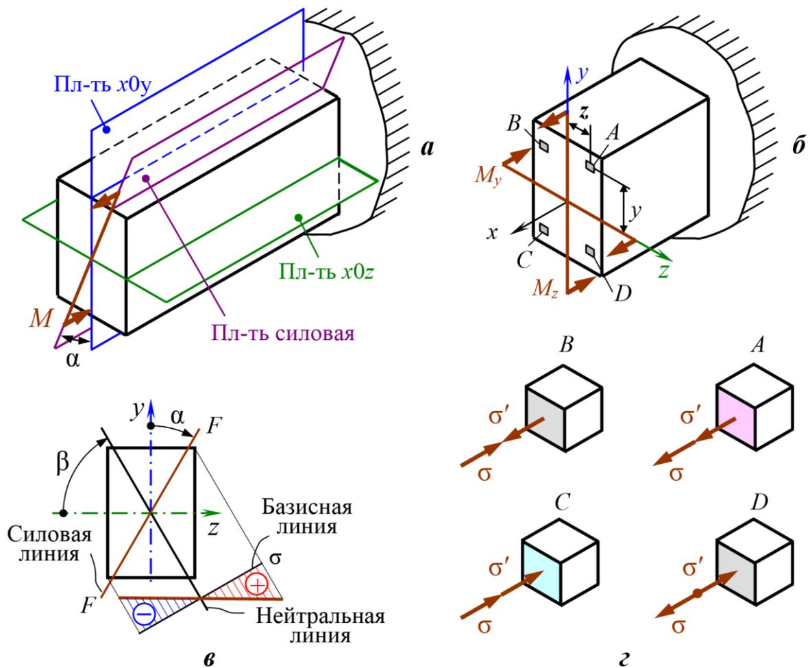
Рис.4.64 . Взаимное положение силовой плоскости и главных плоскостей инерции при косом изгибе (а); внутренние усилия в произвольном сечении бруса (б); характер распределения напряжений в произвольном сечении бруса (в); напряженное состояние в произвольных точках поперечного сечения бруса (з)
