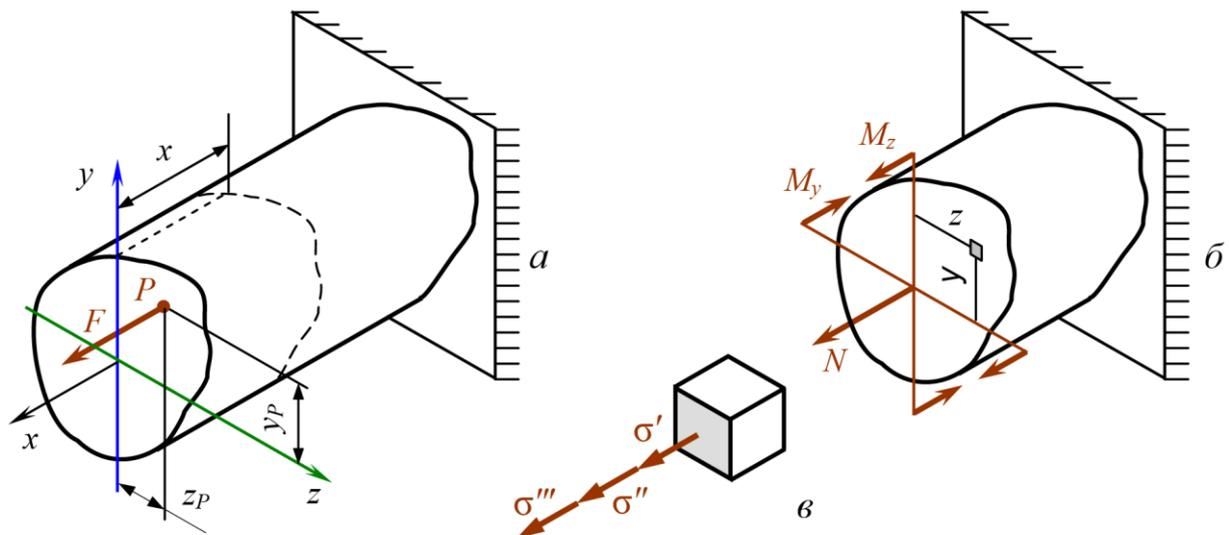
Рис.4.68. Схема к определению внутренних усилий и напряжений при внецентренном приложении силы
