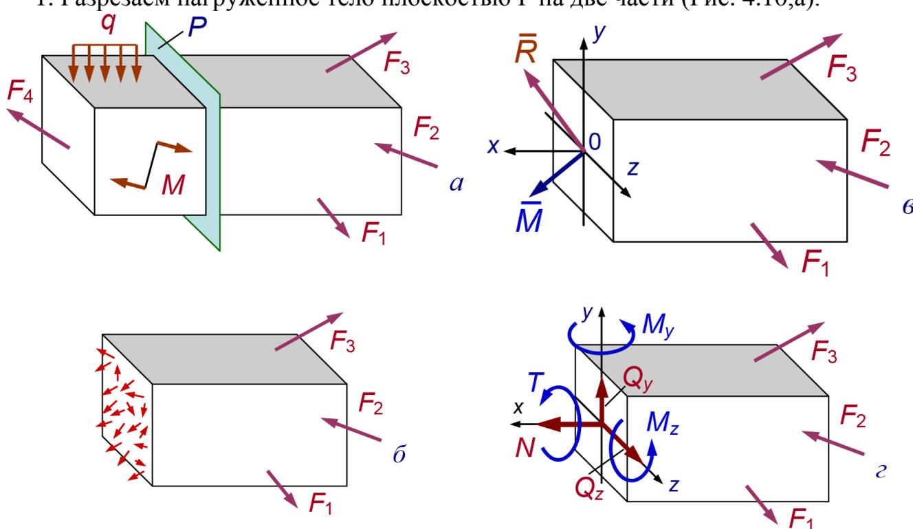
Рис.4.10. Определение внутренних усилий методом сечений
