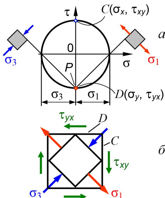
Рис.4.16. Построение круга Мора для определения главных площадок и величины главных напряжений.
