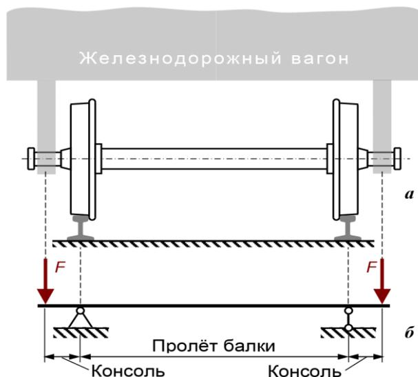
Рис.4.2 Пример реальной конструкции (а) и соответствующей ей расчётной схемы (б)
