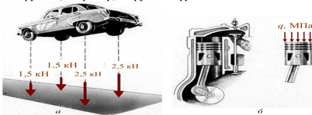
Рис.4.8. Примеры сосредоточенной (а) и равномерно распределенной по площади (б) нагрузок.
