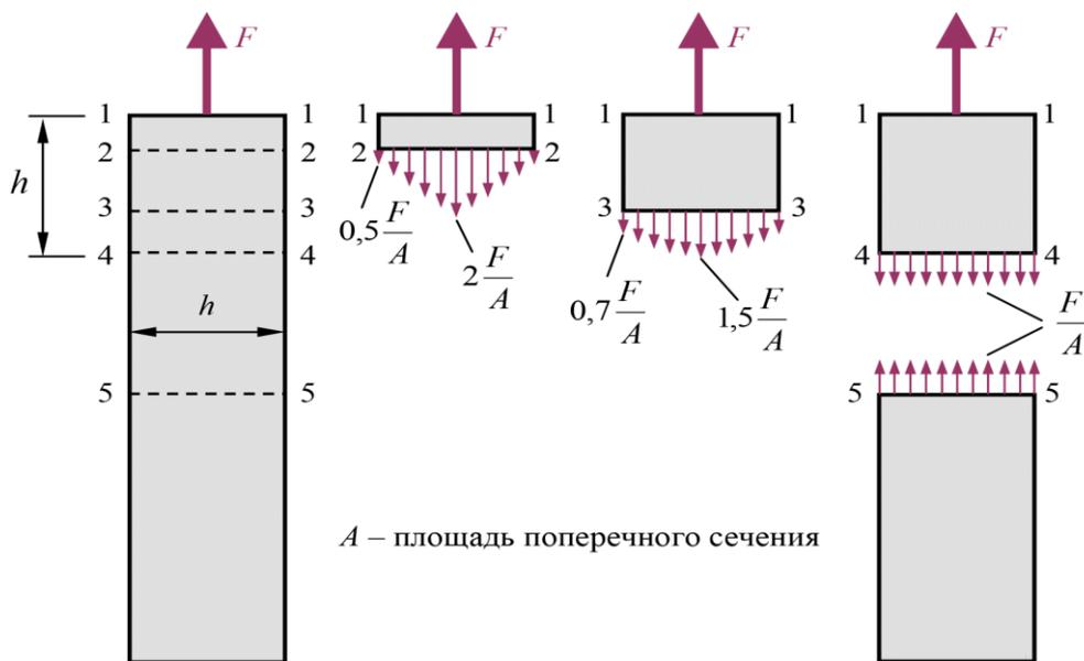
Рис.4.1 Распределение нормальных напряжений в поперечных сечениях стержня при растяжении сосредоточенной силой
