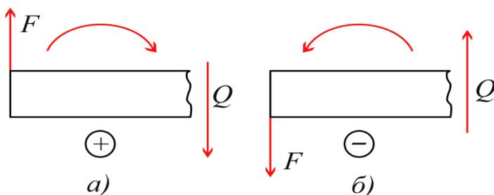
Поперечная сила в сечении считается положительной, если она стремится развернуть сечение по часовой стрелке (Рис.4.41,а), если против, отрицательно (Рис.4.41,б).
