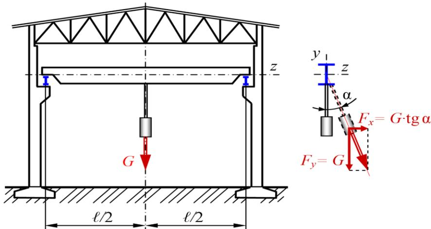
Рис.4.63. В начале движения мостового крана вдоль пролета цеха, при его торможении возникает горизонтальная сила вследствие инерции груза
