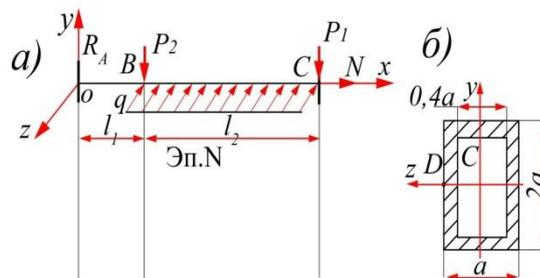
Рис.4.75. Изгиб балки в двух плоскостях, испытывающей растяжение
