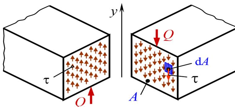
Рис.4.15. Внутренние усилия и напряжения, возникающие в сдвигаемых слоях.
