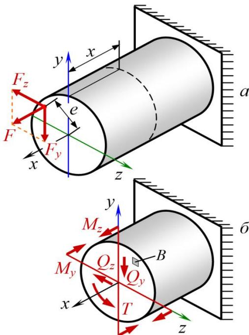
Рис.4.72. Определение внутренних усилий при изгибе с кручением
