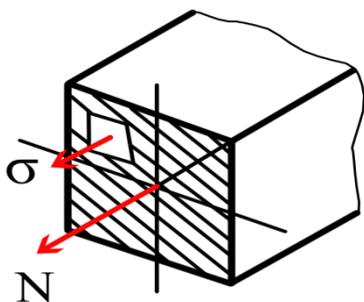
Исходя из гипотезы плоских сечений, можно предположить, что напряжения при растяжении и сжатии в пределах каждого сечения не меняются. Поэтому напряжение можно рассчитать по формуле
