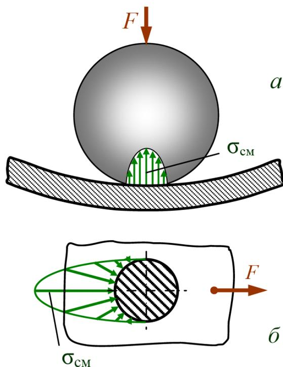
Рис. 4.17. Характер распределения шарика с кольцом (а) и листа с заклепкой (б).
