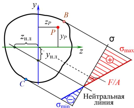
Рис.4.70 Эпюра напряжений в поперечном сечении
