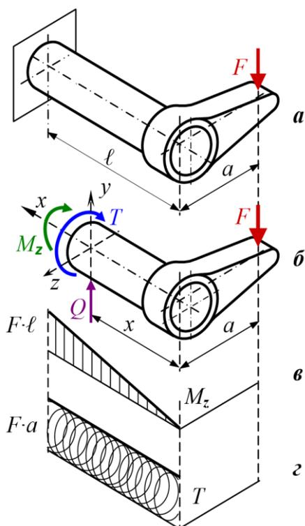
Строим эпюры изгибающего и крутящего моментов, действующих в поперечных сечениях вала (поз. в и г Рис). приведенный момент в опасном сечении—в защемлении:
