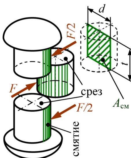
Рис. 4.18. Поверхности среза и смятия в заклепочном соединении.
