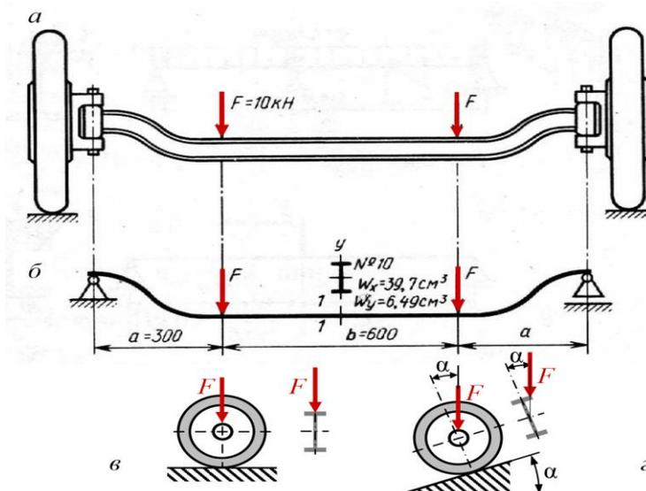
Рис.4.62. При въезде автомобиля на наклонную плоскость линия действия силы  $F$  не совпадает ни с одной из главных плоскостей инерции поперечного сечения балки
