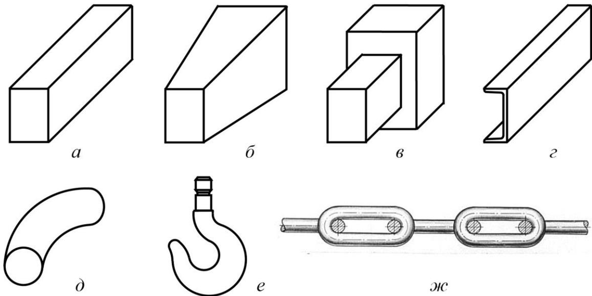
Рис.4.4. Примеры брусьев различной формы
