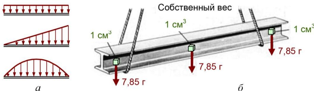
Рис.4.9. Виды распределенной по длине (а) и объему (б) нагрузок.
