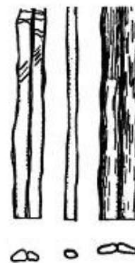
3.6-rasm. Tabiiy ipak tolasining tashqi ko'rinishi va ko'ndalang kesim yuzi
