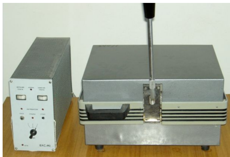
Рис.4 Общая схема термовлагомера ВХС-М1
