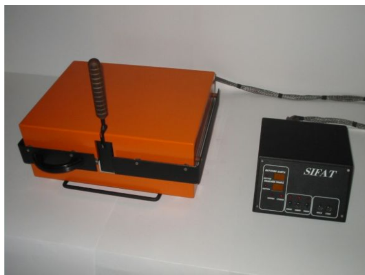
Рис.5 Общий вид прибора “Сифат” для определения влажности хлопка и хлопковой продукции
