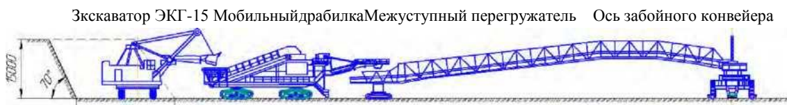
Рисунок 1 - Технологическая схема разработки вскрышных уступов разреза Ангренский
