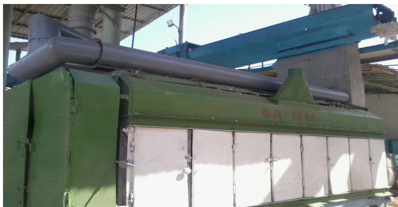
Рис. 8.Общий вид промышленного образца очистителя от мелкого сора
