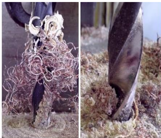
9-расм. Қиринди ҳосил бўлиш жараёни а-амалдаги усулда пармалашда, б-тавсия қилинган усулда пармалашда
