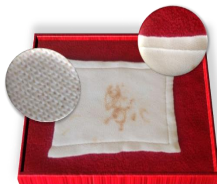
Рис 10. Состояние изношенных трикотажных подэлектродных прокладок после 60 процедур
