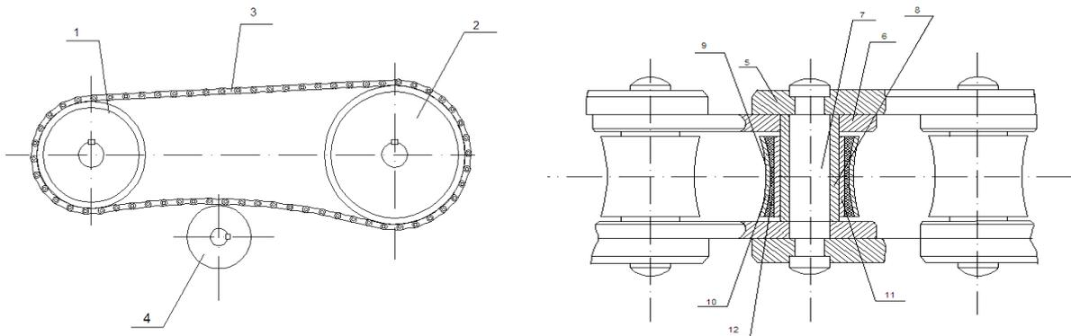
Рис. 2. Схема передачи с цепью с упругим элементам.
