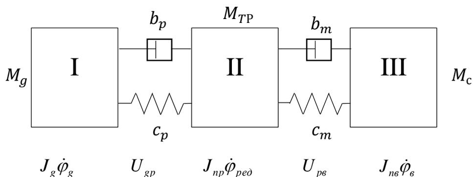
Рис. 3. Расчетная схема машинного агрегата с механизмом привода винтового конвейера для транспортировки и очистки линта.
