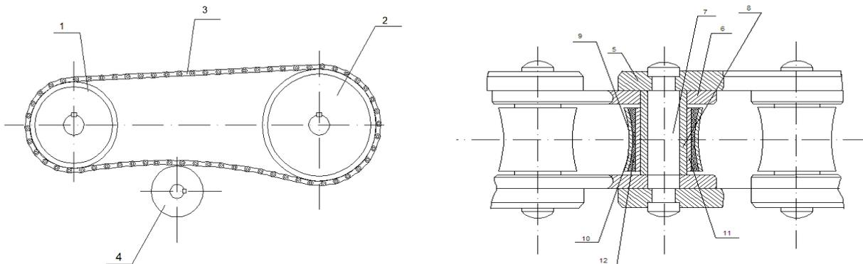
2-расм. Қайишқоқ элементли занжири бўлган узатма схемаси.
