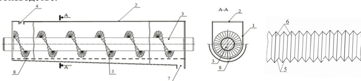
Рис. 1. Рекомендуемая схема винтового конвейера
