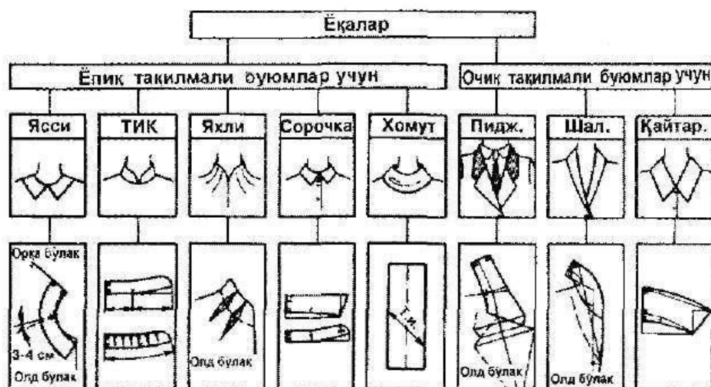
2.43-расм. Ёқалар конструкцияларининг таснифи.
