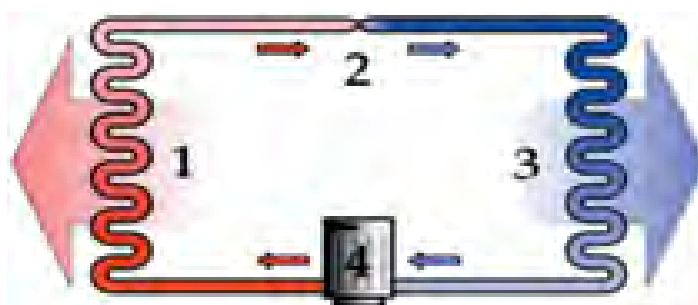
2-rasm. muzlatkichning ishlash sxemasi.
