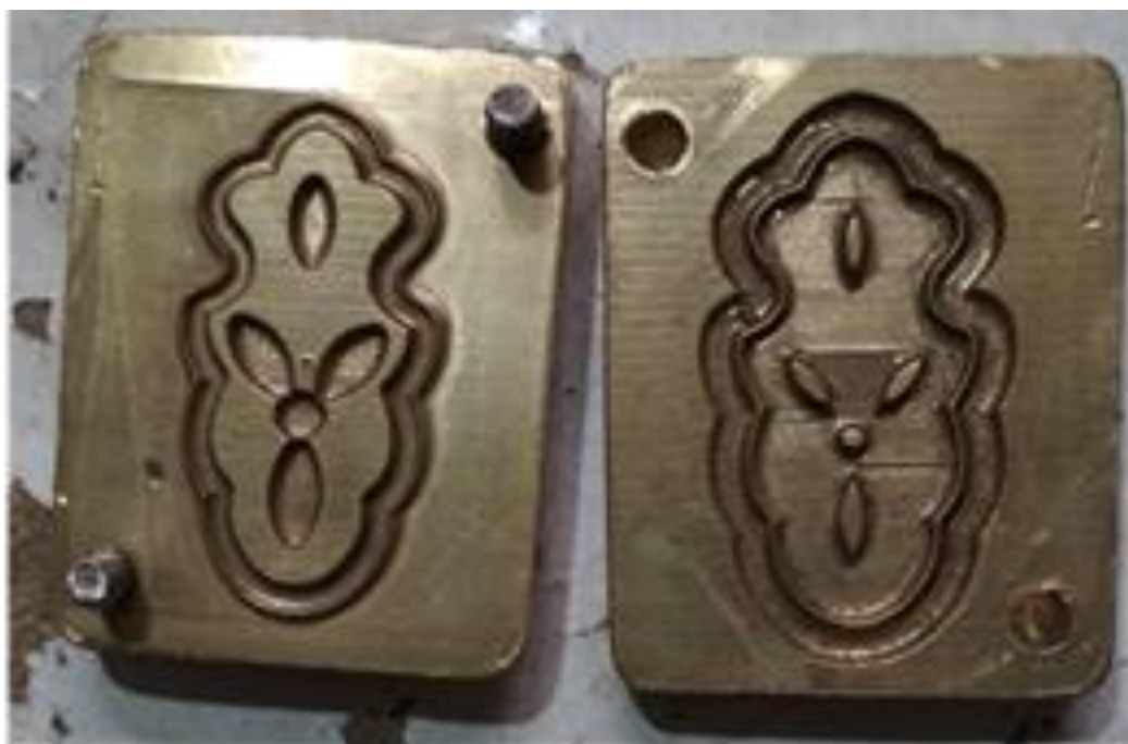
3.13-расм. Рихтагорлик асбоби. Уста Фозил ясаган мис қолип.
