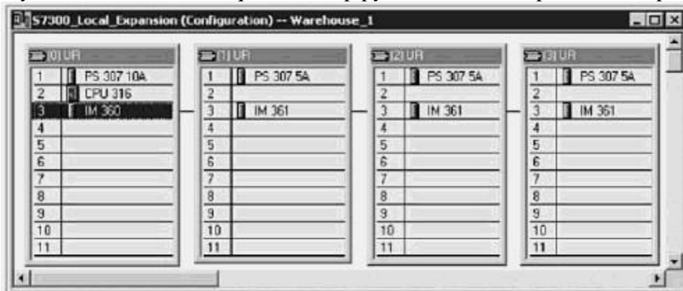
Rasm 3-14. IM360/IM361 ni ishlatgan holda S7-300 lokal kirish/chiqish ning 4 ta ustungacha kengaytmasi.
