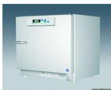
2.24-rasm. Termostat. Doimiy ravishda bir xil temperatura saqlash uchun.
