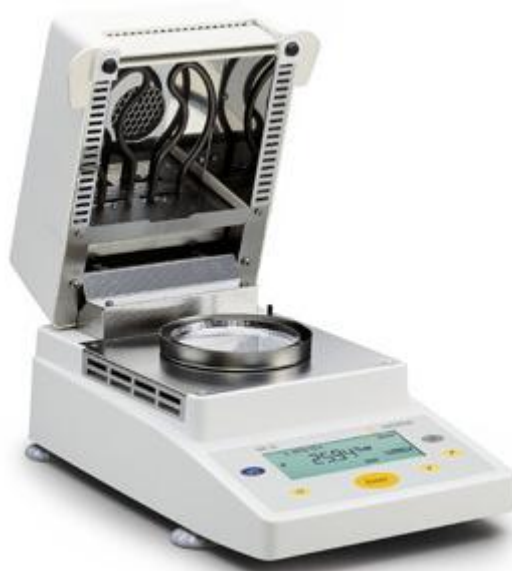
21-rasm. Germaniyaning “Sartorius AG” konserni tomonidan ishlab chiqilgan namlikni aniqlovchi asbob
