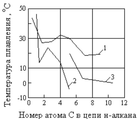
1.1-расм. Моноалмашган н-алканлар эриш ҳароратининг ўринбосар ҳолати ва структурасидан боғлиқлиги: 1-фенилэйкозанлар ( C_{26}H_{46} ); 2-циклогексилэйкозанлар ( C_{26}H_{52} ); 3-бутилдокозанлар ( C_{26}H_{54} ).
