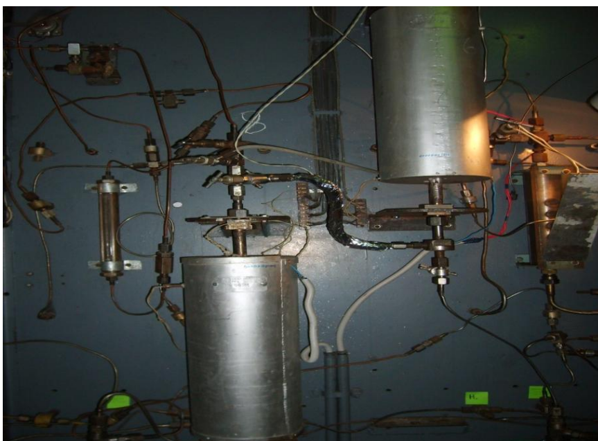
Расм-3.4. Метанолдан ДМЭ синтези ва уни бензинга айлантириш тажриба блоки.
