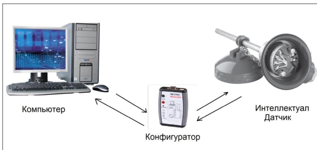
2.3-расм. Метран 2700 нинг конфигуратор Метран-6700 орқали компьютерга уланиш схемаси.
