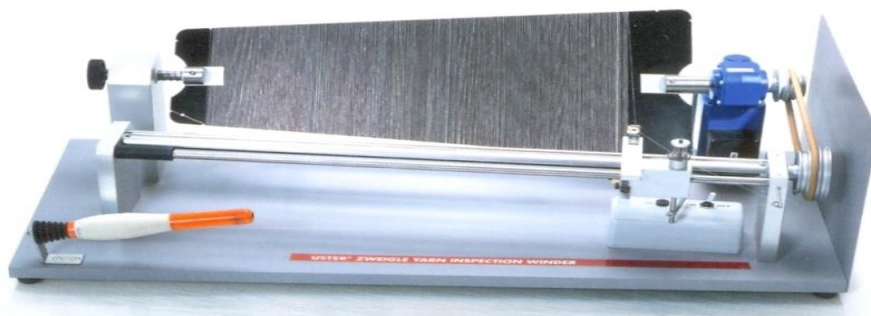
5-расм. USTER ZWIGLE YARN INSPECTION WINDER- Мотовило оргонолептик усулда ипни сифати аниқланади
