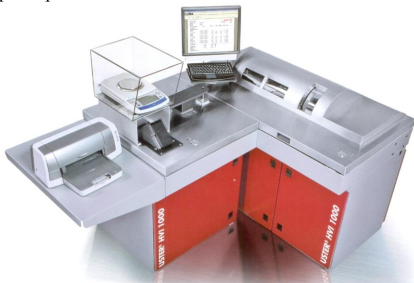
1-расм. Толанинг тўлиқ хосса кўрсаткичларини аниқлашда ишлатиладиган USTER HVI 1000 M1000 асбоби
