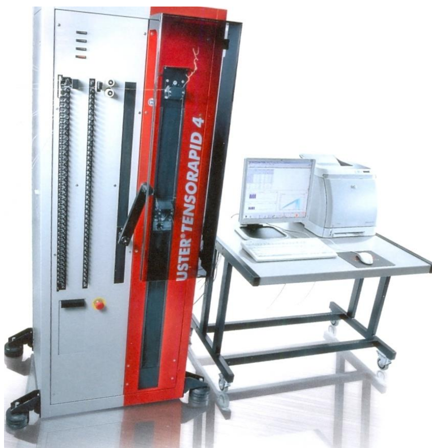
3-расм. Ипни узулиш кучи, узулишдаги узайишни ва узулиш вақтини аниқлаш асбоби
