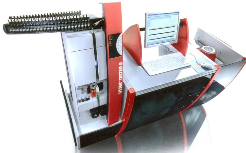
2-расм. Пилта, пилик ва ипни нотекислигини аниқлаш асбоби USTER TESTER 5-S800
