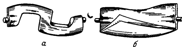
Расм-21. 3 - симон (а) ва роторли (б) кураклар (лопасты)
