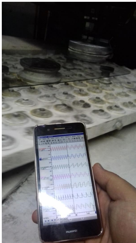
4.3 расмда абразив ишлов беришда хосил бўлган виброакустик сигналларни тахлил қилиш жараёни.
