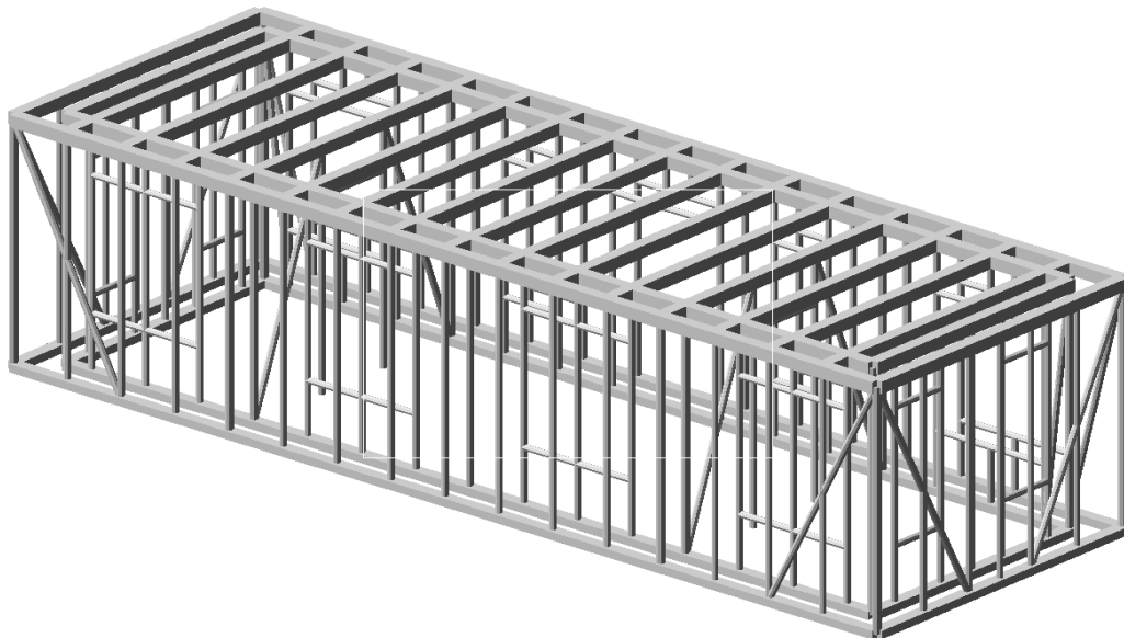
Расм 3.8 № 1, № 2 ва № 3 вариантлар учун тизимнинг моделлаштиришнинг умумий куруниш (пойдевор элементи, синч каркасини тўлдириши, бино томи шартли равишда кўрсатилмаган)
