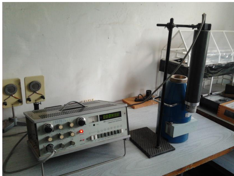
2.2.1-rasm. Stsintillyatsion schyochik, qo'rgoshin uycha va detektor tabiatdagi radioaktivlikni o'lchayapti.
