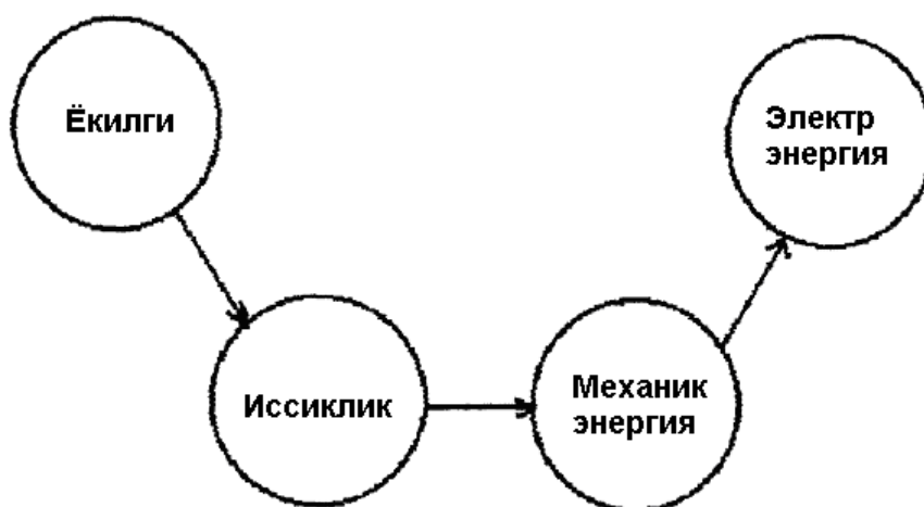
30-расм. Иссиқлик электр станцияларда энергияни қайта ҳосил қилиш схемаси.
