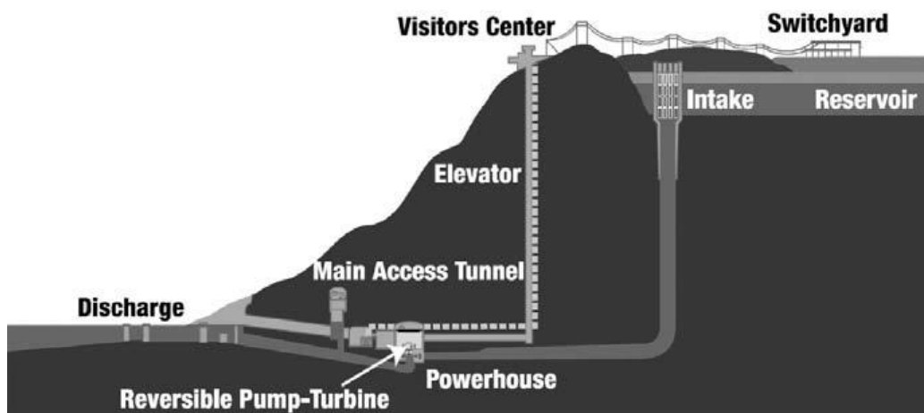
75-расм. Гидроаккумуляцияловчи электр станция
