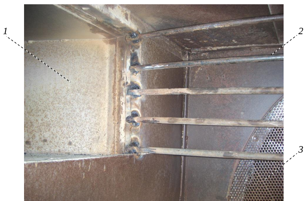
3.7-rasm. Yo'naltirgich payvandlangan kirish qismi 1-kirish quvuri; 2- yo'naltirgich sterjenlari; 3-to'rli yuza.
