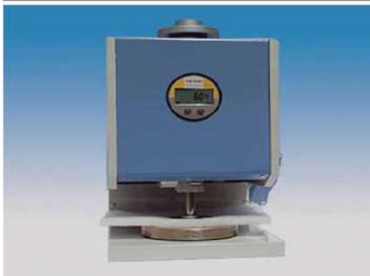
3.2-rasm. Thickness-Lab- to'qima, trikotaj, noto'qima, geotekstil, teri matolarini qalinligini aniqlash asbobi.
