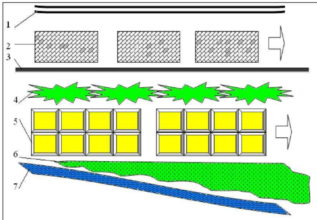
1-rasm Sanoat rayonini rejalashni lentasimon sxemasi: 1- tasqi temir yo'l transporti; 2 - sanoat rayoni zonasi; 3 - yuklar uchun avtomagistral; 4- sanitar - himoya zonasi, 5 - seliteb zona (yashash rayoni), 6-ko'kalmazor zona; 7-suv havzasi
