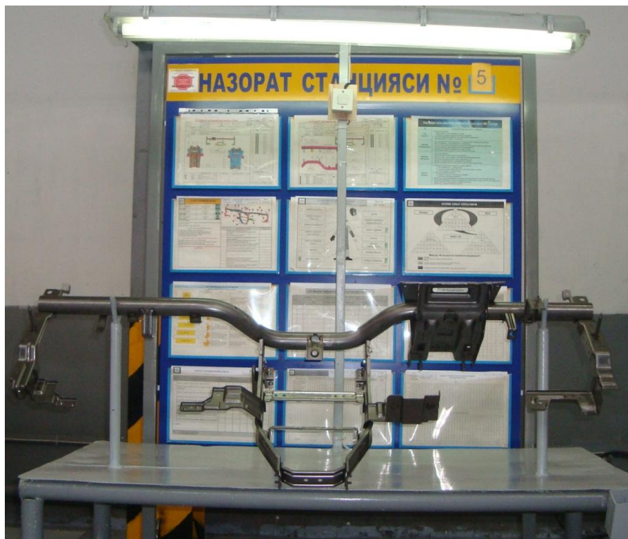
T250 TIE BAR линияси назорат станцияси
