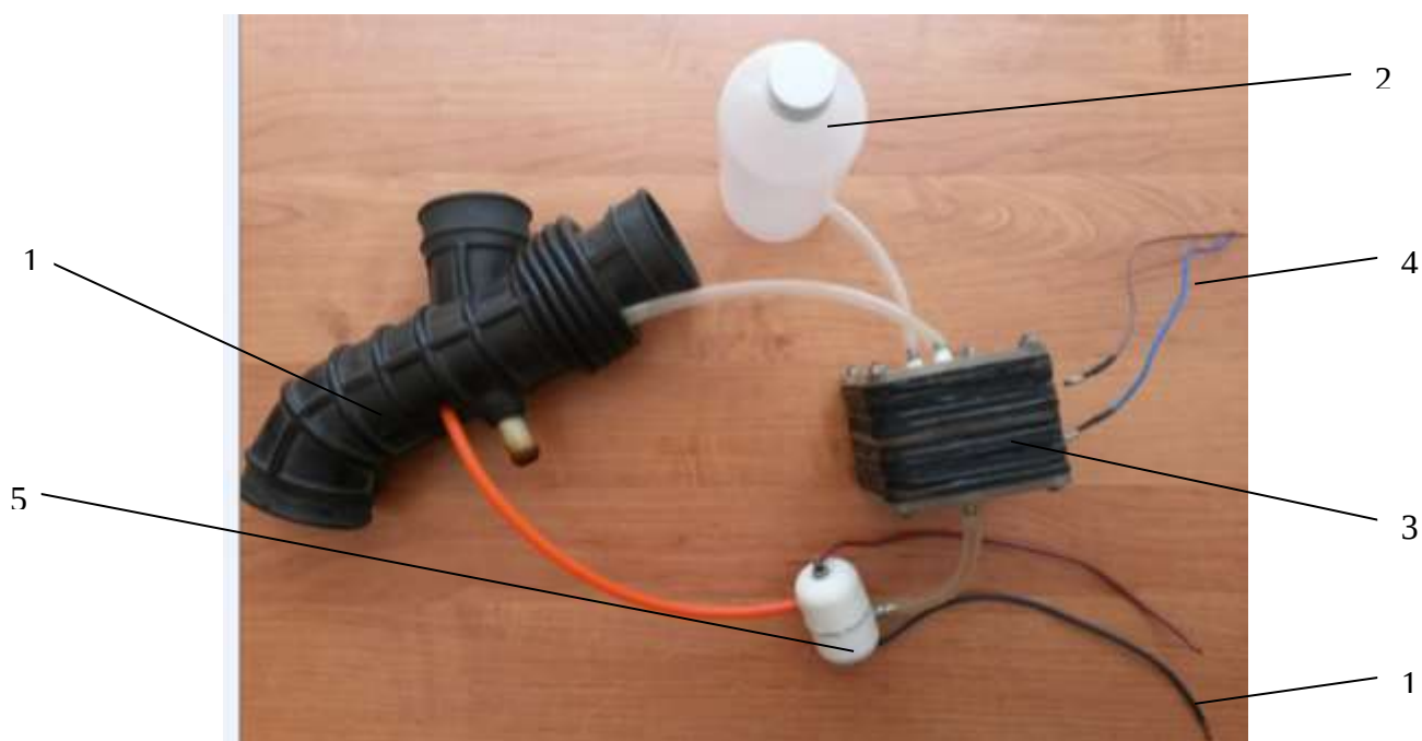
33- rasm. “Neksiya” avtomobili uchun yasalgan vodorod generatori.
