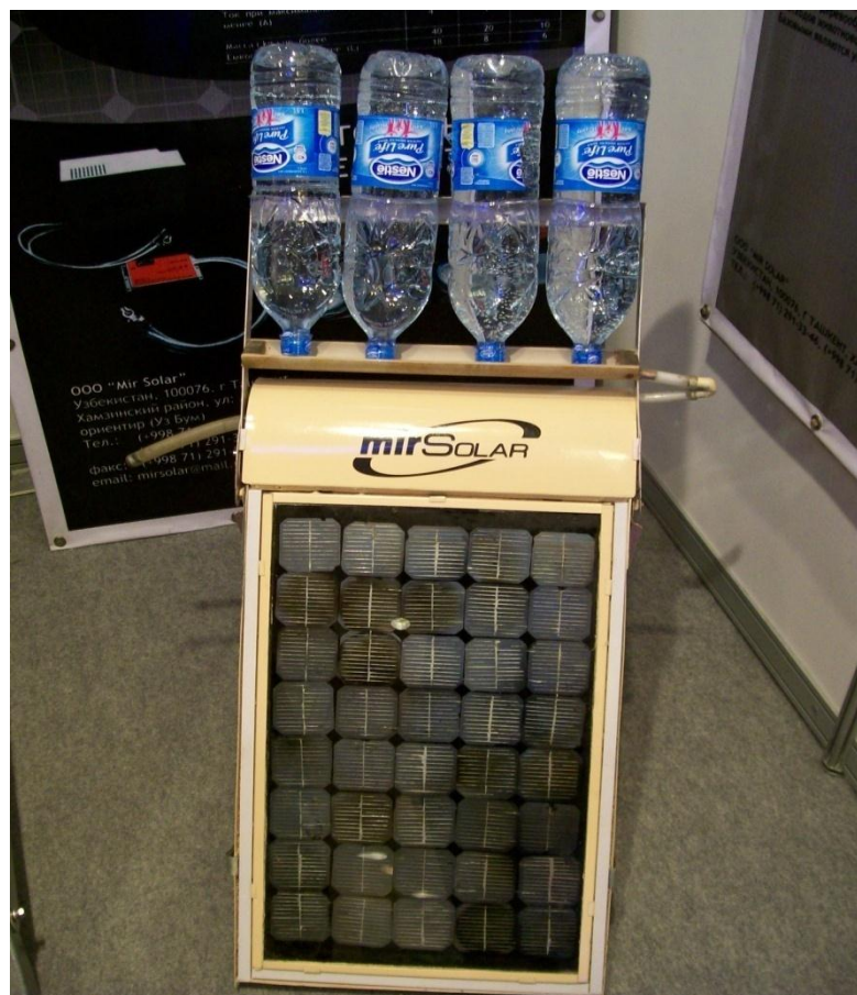
Рис.2.3. Переносная опытная ФТП установка на основе СЭ. а – площадь фотоэлектрической батареи 490 x 310, б – емкость резервуара для горячей воды 6 литров, в – емкость коллекторной части 3 литра, вес без воды – 13 кг.
