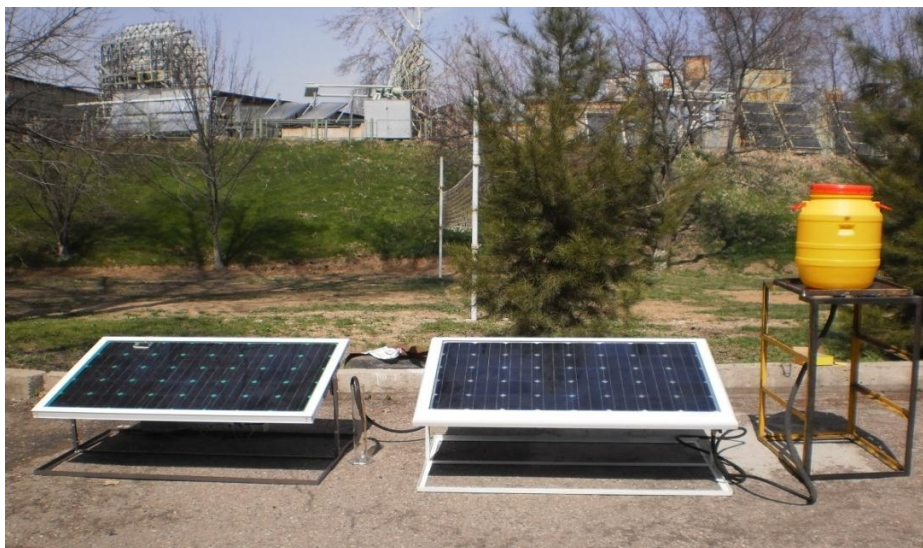
Рис.2.5. ФТБ (справа) и ФЭБ (слева) во время испытания на солнечном полигоне Физико-технического института
