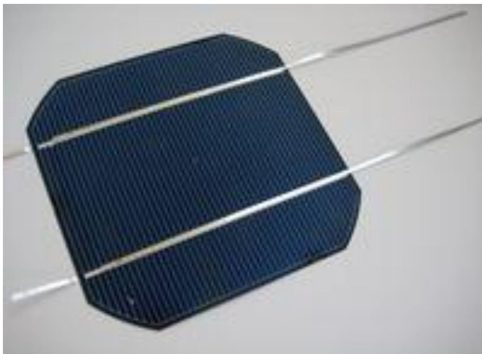
Рис.1.6. СЭ с напаянным плоским проводником (монтажной медной шиной)
