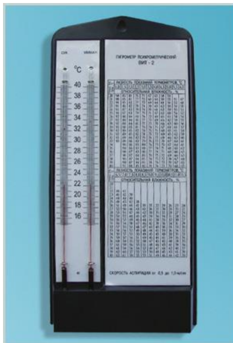
16-Расм. Ҳарорат ва намликни ўлчайдиган асбоб.
