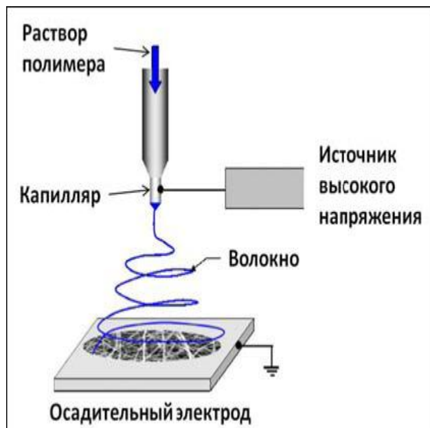
138-расм. Электроспиннинг методи асосида тола тайёрлаш қурилмасини схементи
