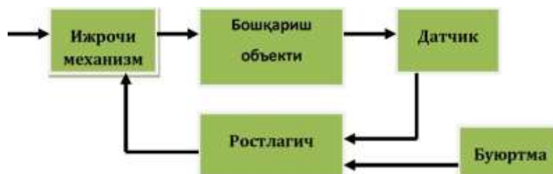
19-rasm. Haroratni avtomatik rostlash tizimining strukturaviy ko‘rinishi
