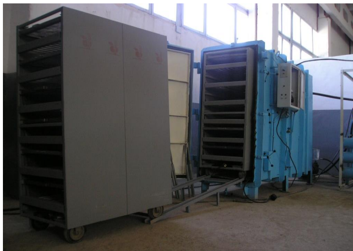
Рис.1. Лабораторная вакуумная сушильная установка для овощей, фруктов и продукции лесного хозяйства с инфракрасными излучателями для нагрева продукции.
